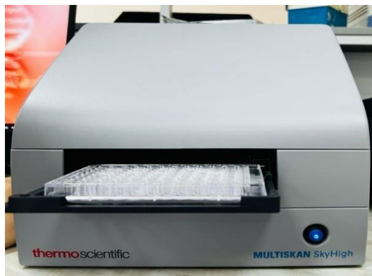
10 сурет - Thermo scientific Multiskan SkyHigh микропланшетті спектрофотометрі
