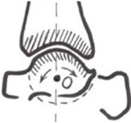
Рисунок 15 – Пространственный шарнирный механизм «изогнутая плоскость – цилиндр» с одной степенью свободы ( W = 1 ): а – сагиттальная плоскость, б – фронтальная плоскость. Где: O – центр цилиндра; O_1 - O_2 – фронтальная ось вращения шарнира
