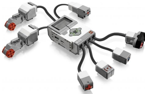
Сурет 2. Датчиктері мен сервомоторлары бар LEGO Mindstorms EV3 контроллері
